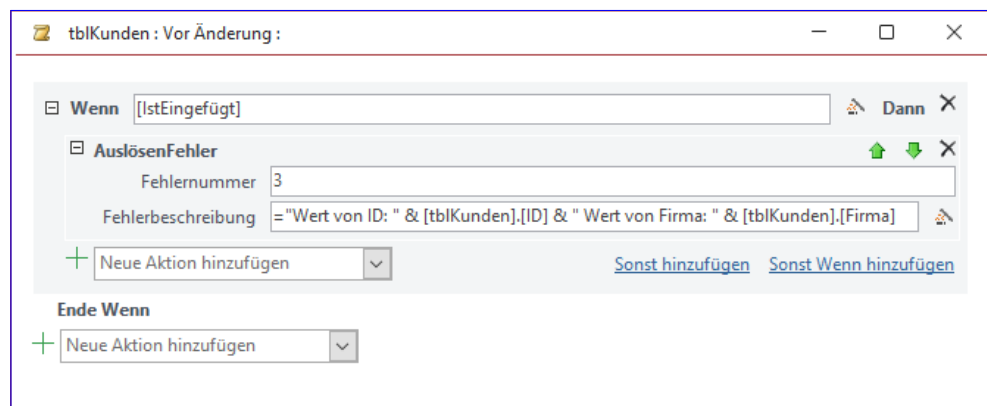
Bild 2: Makro, um herauszufinden, ob das Feld ID beim Ereignis Vor Änderung bereits gefüllt ist.
